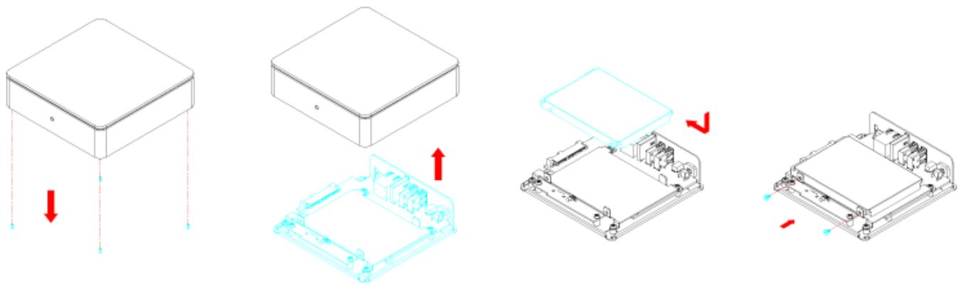
將上蓋向下與底座接合，鎖上底座的四顆螺絲，貼上腳墊即完成。
